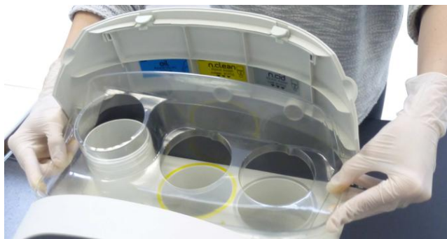
Abbildung 28: Austausch des Kunststoffschutzes
