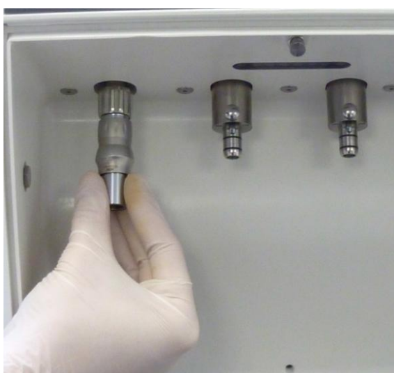
Figure 16 : Changement d'adaptateur turbine
