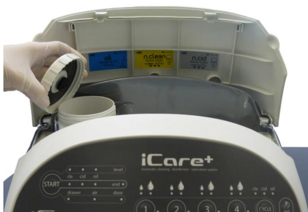
Figure 12 : Dévissage du bouchon du réservoir d'huile de l'appareil iCare+
