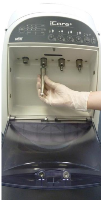
Abbildung 17: Anschluss eines Hand-/Winkelstücks
