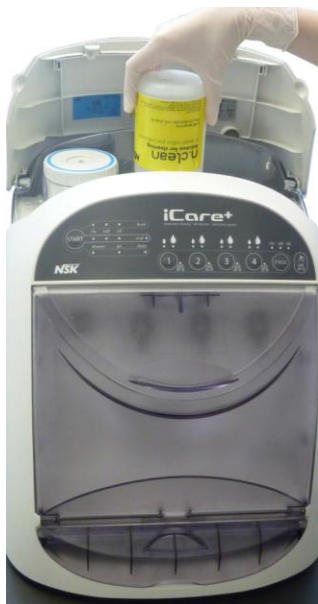
Abbildung 10: Einsetzen der n.clean Flasche (500ml)
