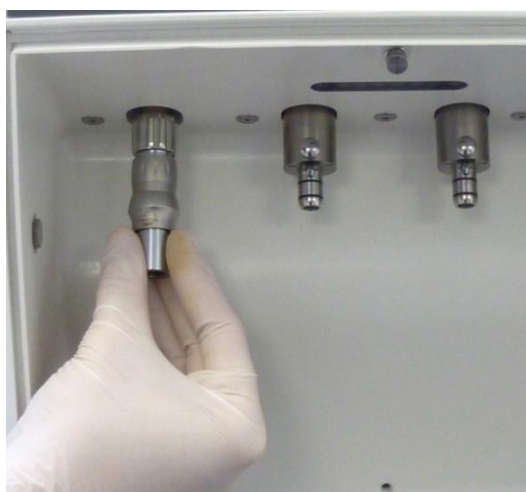
Abbildung 16: Anschluss bzw. Wechsel eines Turbinenadapters
