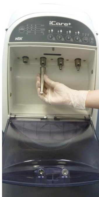
Figure 17 : Connexion d'un contre-angle
