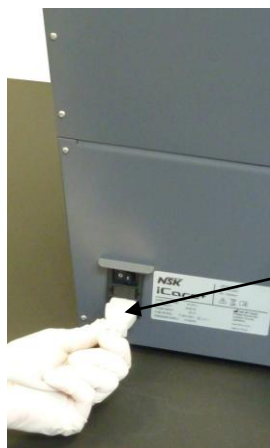
Figure 8 : Connexion de l'appareil iCare+ au réseau électrique
