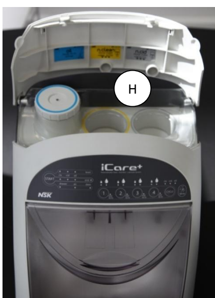
Abbildung 4: Gehäuse für Verbrauchsmaterialien und USB-Anschluss
