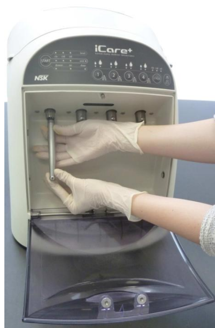
Abbildung 15: Festschrauben des Halterings am Midwest-4-Loch-Anschluss
