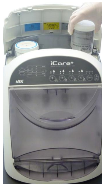
Figure 11 : Connexion de la bouteille de n.Cid (500 mL)
