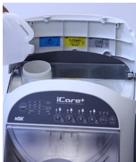
Figure 13 : Remplissage du réservoir d'huile de l'appareil iCare+
