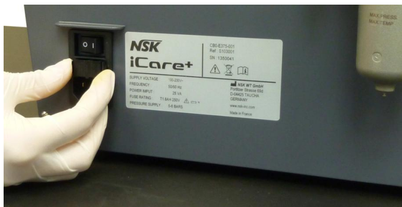
Figure 30 : Boîte à fusible de l'appareil iCare+
