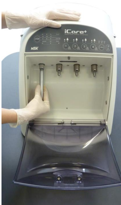
Abbildung 14: Anschluss einer Turbine (Typ Midwest 4-Loch)
