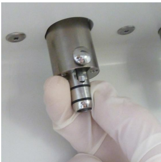
Abbildung 29: O-Ringe des ISO-E Adapters
