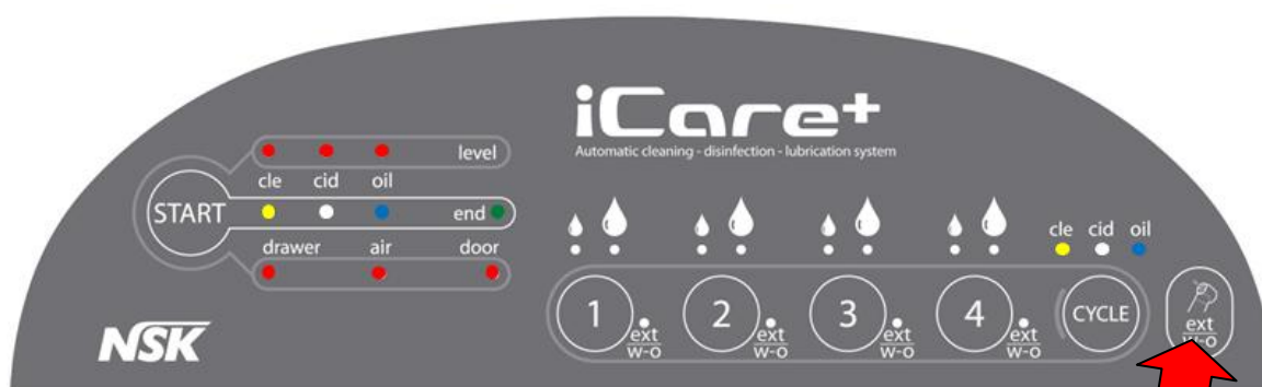
Bouton pour la sélection d'un instrument avec Spray externe/ou sans Spray
