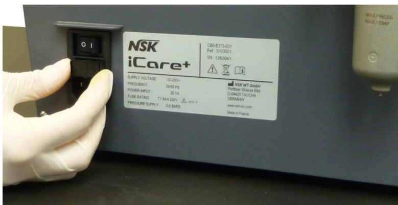
Abbildung 30: Sicherungsgehäuse von iCare+
