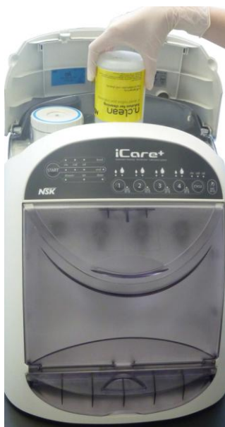
Figure 10 : Connexion de la bouteille de n.Clean (500 mL)
