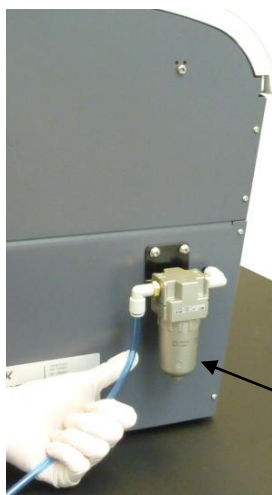
Abbildung 6: Verbindung des Druckluftschlauchs mit dem pneumatischen System von iCare+
