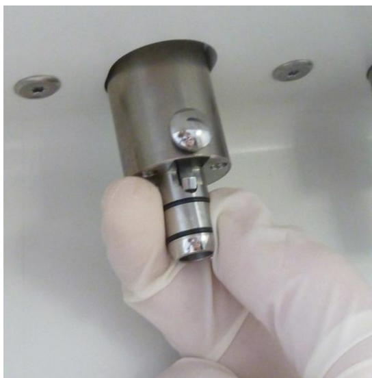
Figure 29 : Joints toriques du connecteur E-type
