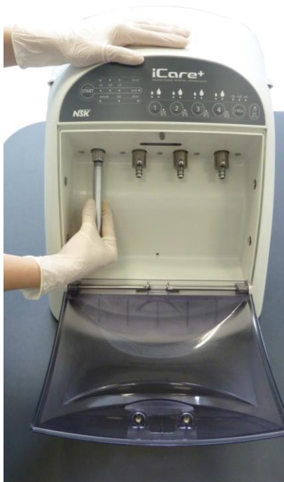
Figure 14 : Connexion au connecteur turbine
