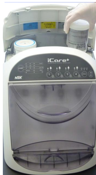
Abbildung 11: Einsetzen der n.cid Flasche (500ml)
