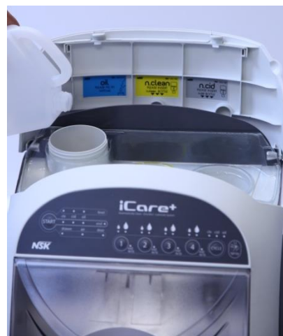
Abbildung 13: Befüllen des iCare+ Öltanks
